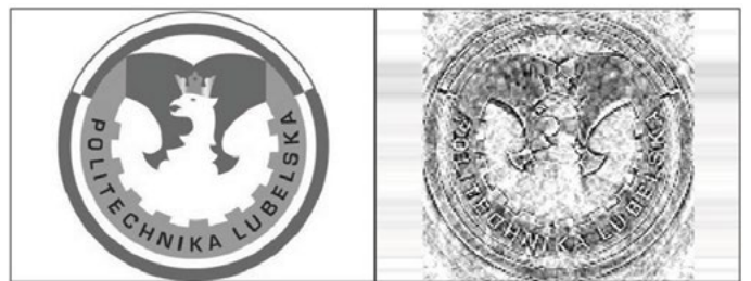
Rys. 12. Znak wodny (po lewej) oraz wyizolowany znak wodny z rozmytego obrazu (po prawej) oznakowanego metodą DWT-SVD
